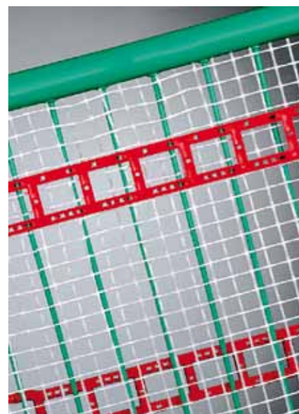
Obr. 3 Detail kapilárnej rohože: kapilárne rúrky napojené na rozvodné potrubie sú pokryté sklotextílnou sieťou. Na rohoži je pripevnený rebřík na zabezpečenie pravidelných rozstupov
